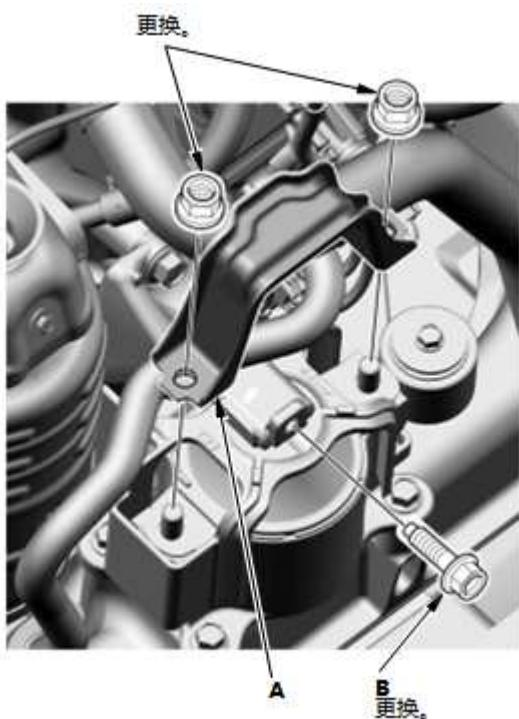
1. 拆下发动机前支座挡块 (A)。
